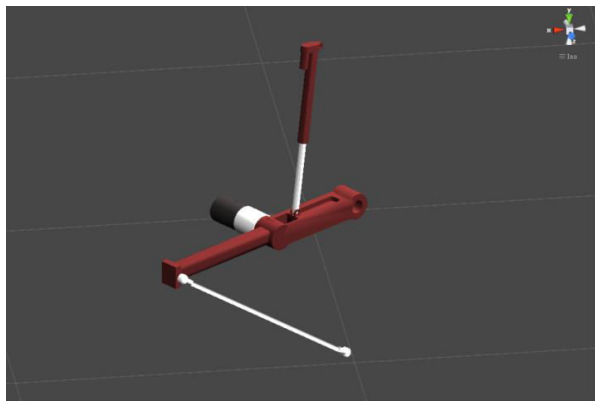
Figura 3: Montaje de una cadena cinemática del robot dentro de Unity 3D.
