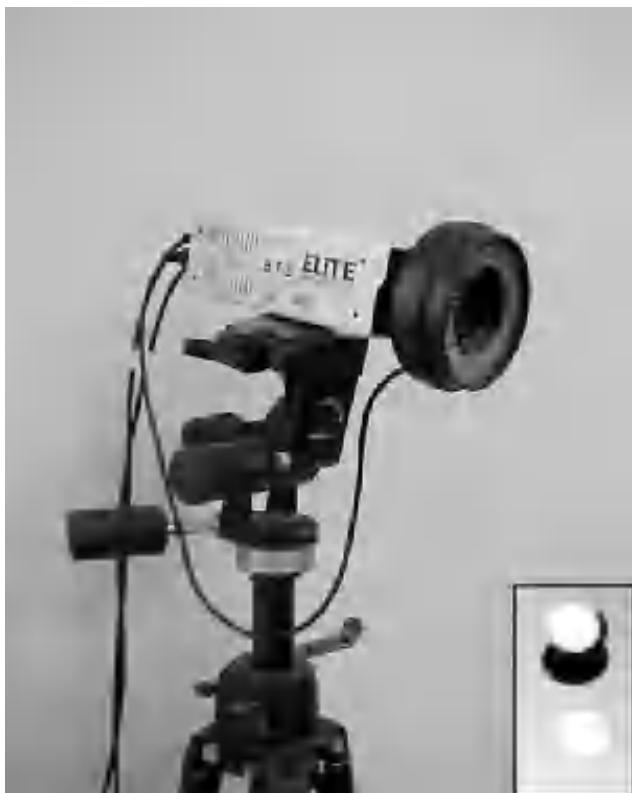
Figura 3 Cámara CCD y marcadores de infrarrojo (IR).
