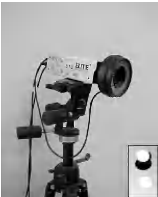
Figura 3 Cámara CCD y marcadores de infrarrojo (IR).
