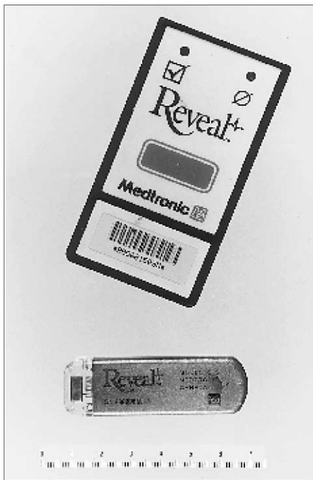
Fig. 1. Componentes del sistema de Holter implantable subcutáneo Medtronic Reveal. En la parte superior, activador externo del sistema. En la parte inferior, registrador implantable.
