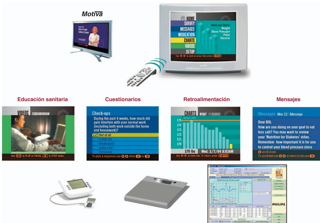
Figura 1. Instrumentos de telemonitorización utilizados a través del televisor del paciente. La imagen inferior muestra el equipo de telemonitorización del peso y la presión arterial y se visualiza un gráfico de las constantes vitales en el ordenador de la unidad de insuficiencia cardíaca.
